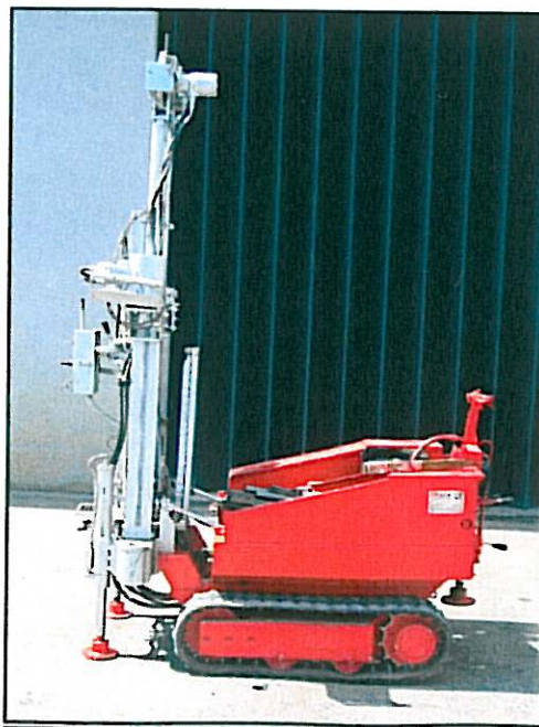
Foto 1 – Máquina MK2 utilizada nas sondagens DPSH.
